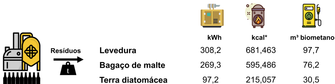
Figura 4: Esquema de geração de energia a partir de 1 tonelada de resíduo.
